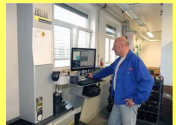
ZOLLER 公司为 GMN 公司提供的解决方案：采用 TMS 刀具管理解决方案的刀具预调仪设备
