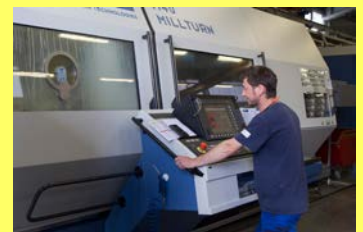
有序的刀具管理带来了收益：通过使用 HSK-100 刀具柜按序管理刀具，停机时间平均缩短了 90 分钟。
